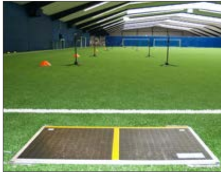
Abb. 38 Startplatte zur exakten Messung der zyklischen Schnelligkeit mit Zwischenzeiten in einer Halle mit Kunstrasenbelag (eigene Darstellung)
